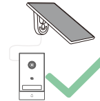
Biztosítani, hogy a tápkábel természetesen, feszültség nélkül feküdjön
